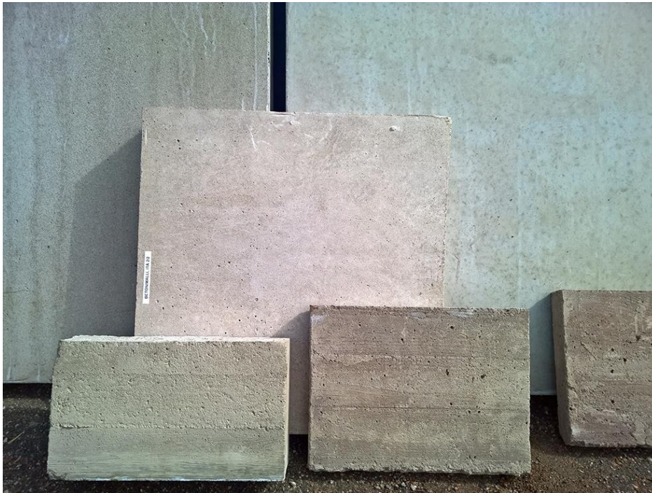
Mallien avulla etsittiin uudelle betonille alkuperäisen betonin värisävyä ja pinnan karkeutta. Kuva: Timo Jeskanen.
